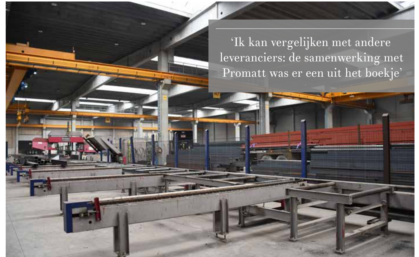
Het vertrekpunt van ongeveer 90% van alle orders is de zaagafdeling die de profielbalken perfect op maat snijdt. De volautomatische Behringer zaagmachine die er staat was dan ook als eerste aan de beurt bij de verhuis.
